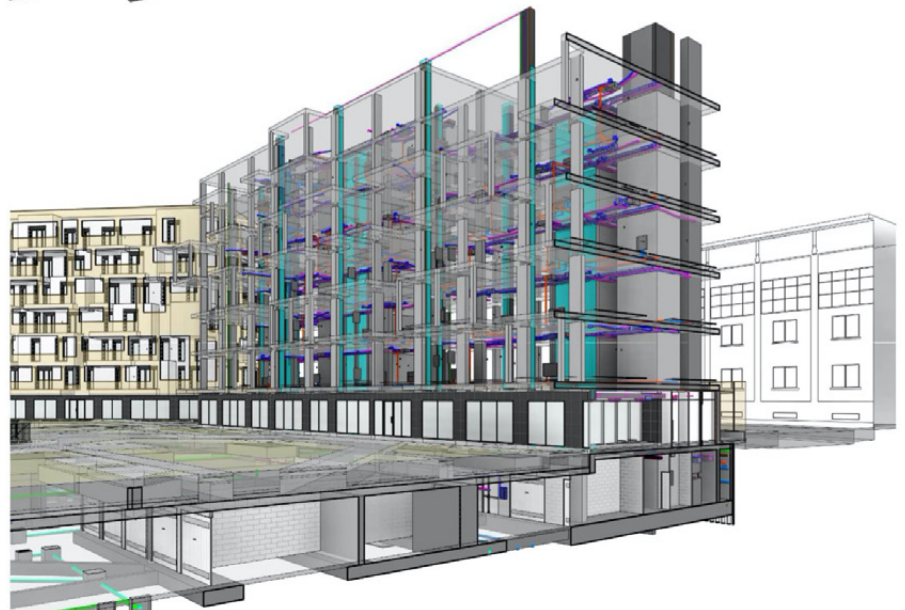
In alto: vista del modello BIM del complesso - discipline Architettonico e MEP; in basso: vista assometrica del complesso
